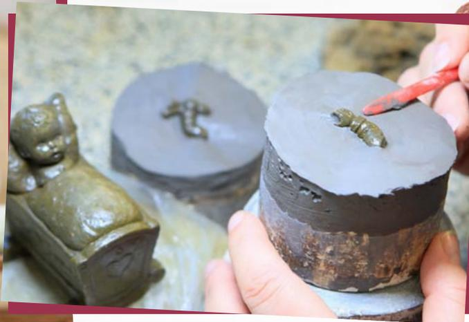
Modell- und Formenbau: Yvonne Hofmann hat die Einzelteile des Original-Tonmodells sorgfältig in Ton eingebettet. Anschließend fertigt sie die Mutterform.
