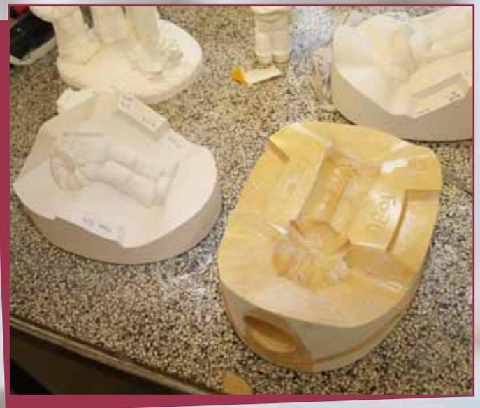
teile, für die im Modell- und Formenbau die Mutterformen sowie die Arbeitsmodelle und -formen für die Gießerei erstellt werden.
